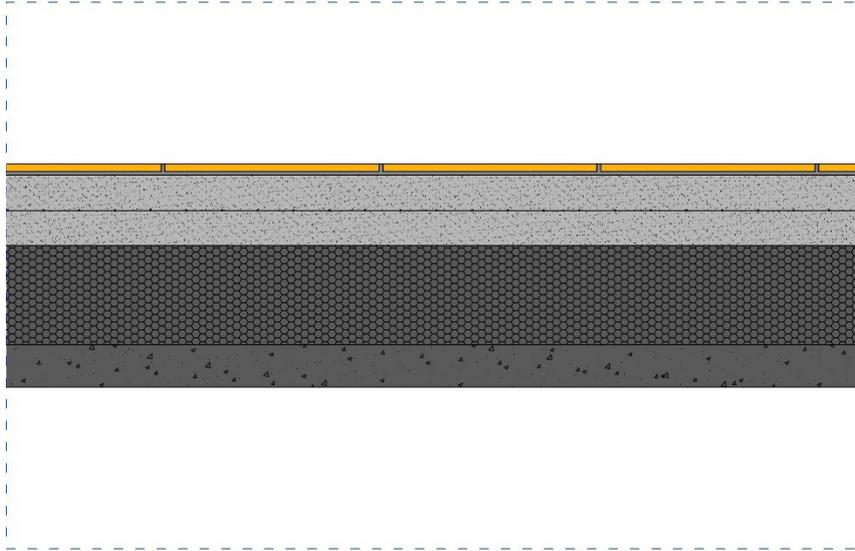
Sopra alla soletta verrà posata lo strato di isolamento in EPS grafitato da 14cm e gettato in opera un sottofondo di cemento magro da 10 su cui verrà poi posata la pavimentazione.
