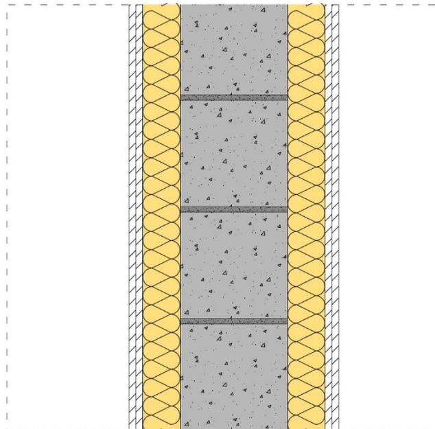
Per le strutture di base con indice  $R_w$  compreso tra 20 e 60dB, l'incremento dell'indice di valutazione del potere fonoisolante per ulteriori strati può essere valutato dalla frequenza di risonanza  $f_0$  arrotondato alla frequenza centrale di banda di terzo d'ottava nella quale rientra. L'incremento è valutato secondo il prospetto D.1 della Norma Tecnica UNI EN ISO 12354-1:2017. Per frequenze
