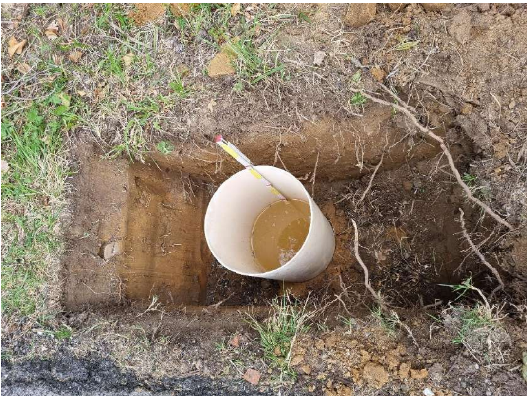
Figura 3 -Dettaglio prova di permeabilità n.1.
