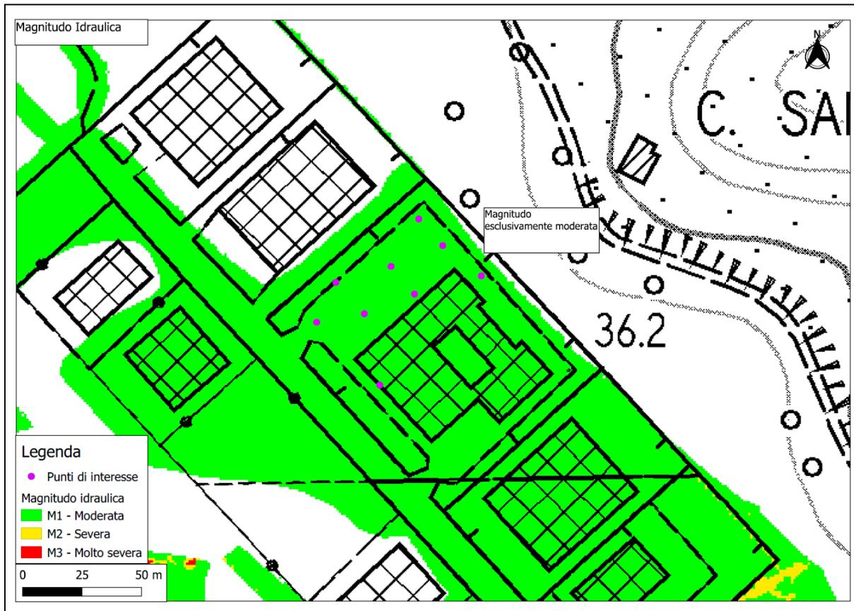
Figura 9 – Immagine con Magnitudo idraulica per tempo di ritorno pari a 200 anni.
